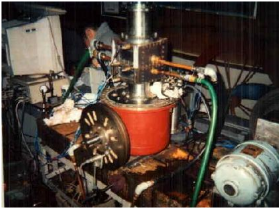
熱水を熱源とする \alpha 型低温度差スターリングエンジン(1997 年試作)
