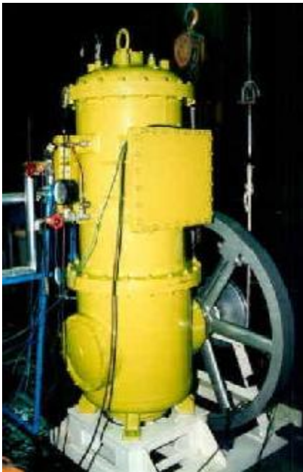
1kW級低温度差スターリングエンジン(1997 年製作)
